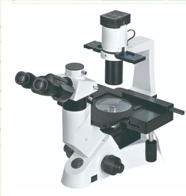
(圖三,倒立顯微鏡)
